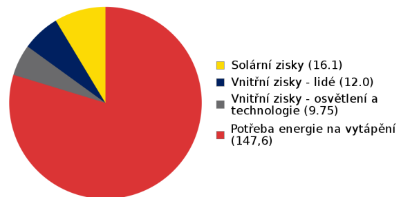
Bilance potřeby energie na vytápění (MWh/rok)
